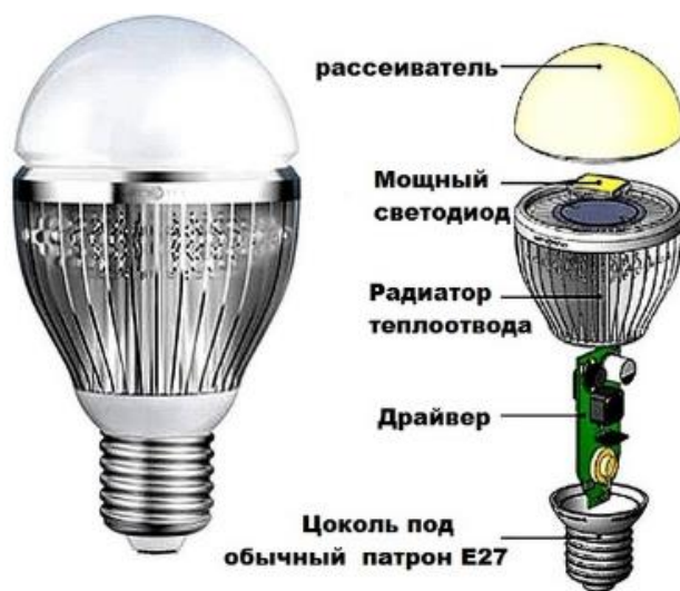
Рис. 3.8. Устройство светодиодной лампы
